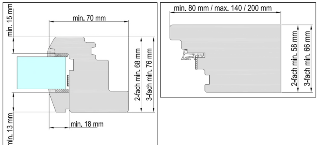
310-2 Minimale Abmessung des Rahmen- und Flügelquerschnitts (Angaben in mm)
