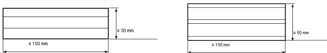
Abbildung P-3: Hauptabmessungen des Probekörpers mit einer (links) bzw. zwei parallelen (rechts) mittigen Schälbahnen
